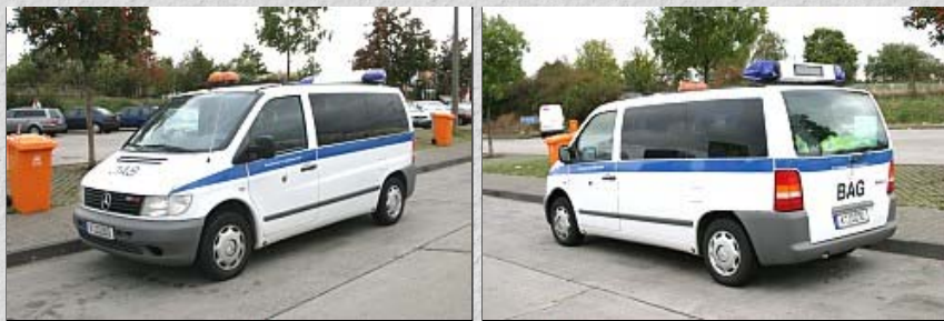
Ein Vorbild des neuen Herpa-Modells auf MB-"Vito". Sichtbar die gelbe Schutzhaube für den Infrarot-Receiver im vorderen Dachbereich rechts und der Blaulichtbalken mit heckseitig eingelassenem Streulicht.
