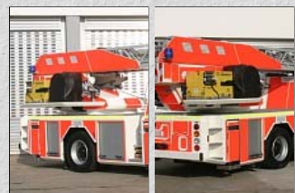
Das Vorbild im Bereich des Leiterstuhls: Sichtbar die Leiter-Halterung mit ihrer Struktur sowie die rechtsseitige Anordnung des Stromerzeugers, des Lüfters und des Werfers. (Bilder: Wolfgang Jendsch)
