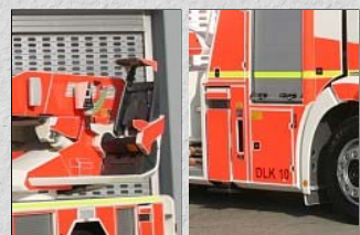
Der Arbeitsplatz des Maschinisten (Bild links): Sichtbar auch die Kopfabdeckung. Beschriftung rechts- und linksseitig mit „DLK 10“. (Bilder: Wolfgang Jendsch)
