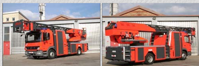
Die Metz-Drehleiter "L 32" in einem völlig neuen Design. Das leuchtrot lackierte Fahrzeug ist mit einem anthrazitfarbenen Leitertank sowie mit ebenfalls anthrazitfarbenen Stossstangen und Lamellenverschlüssen der Gerätekästen ausgestattet. Die Konturen des gesamten Fahrzeug - so die Verkleidung des vorderen Gerätekastens und des Leitertank - wurden abgerundet. Der komplette Leitertank wurde der modernen Optik baulich angepasst. (Bilder: Wolfgang Jensch)
