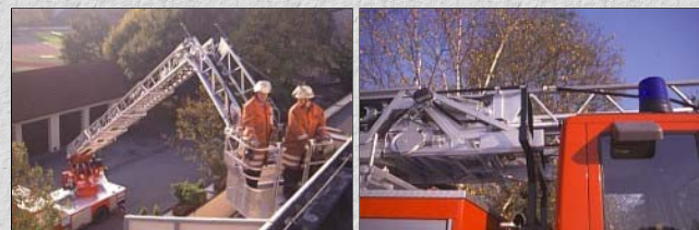
Im Bild links der abknickbare Leiterteil der L 32 A (Articulated - mit absenkbarem Korb-/Leiterteil); im Bild rechts der hinter der Fahrerkabine abgelegte vierteilige Leiterpark sowie das über die Fahrerkabine hinaus laufende fünfte Leiterteil. (Bilder: Wolfgang Jendsch)
