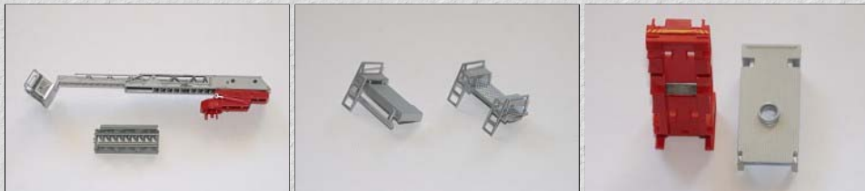
Umbauarbeiten im Detail: Im Bild links die gekürzte, tiefer gelegte und mit einem abknickbaren Leiterteil versehene fünfteilige Drehleiter der "L 32 A"; im mittleren Bild die Abdeckungen des vorderen Gerätekastens (links hoch mit einer Aufstiegsleiter, rechts flach mit zwei Aufstiegsleitern); im Bild rechts die Aussparungen (unbearbeitet) für die Bedieneinrichtungen im Heckteil des Leiteraufbaus. (Bilder: Wolfgang Jendsch)
