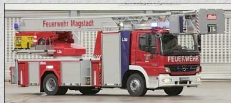
Die "L 32" auf Mercedes-Benz 1529 Atego in ihrer Standardversion. Das Fahrzeug der Freiwilligen Feuerwehr Magstadt entspricht im Wesentlichen dem Herpa-Modell. (Bild: Metz/Rosenbauer)
