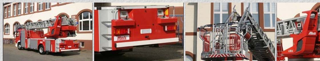
Die "L 32 A" noch einmal von hinten sowie mit dem Aufbauheck im Detail, dem neu gestalteter Rettungskorb und dem Bedienstand. (Bilder: Wolfgang Jendsch)
