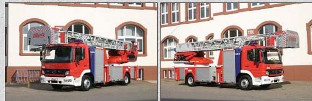
Die Metz-Drehleiter "L 32 A" (Articulated) mit abknickbarem fünften Leiterteil. Dabei werden vier gekürzte Teile des Leitersatzes auf dem vorderen Gerätekasten abgelegt, das abknickbare fünfte Leiterteil ragt über das Fahrerhaus nach vorn hinaus. (Bilder: Wolfgang Jendsch)
