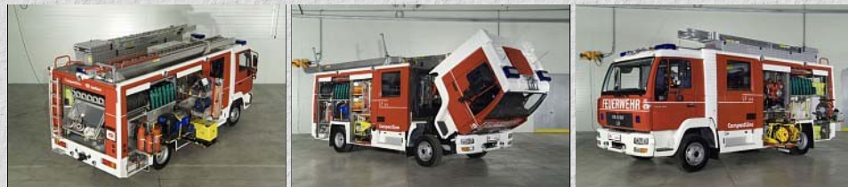
Das LF 10/6 CL von Rosenbauer auf einem MAN-Fahrgestell. Im Bild links gut sichtbar die Leiter-Halterungen sowie der Unterbau für die Steckleitern und die Aufstiegshilfe (fehlt am Wiking-Modell) -, im mittleren Bild das abgeklappte Fahrerhaus (beim Modell nicht möglich) und im Bild rechts das kompakte Design des Fahrzeuges einschließlich der Umfeldbeleuchtung am oberen Dachrand des Aufbaus. Die Blaulicht-Frontblitzer sind seitlich des Frontgrills angebracht (Bilder: Rosenbauer).
