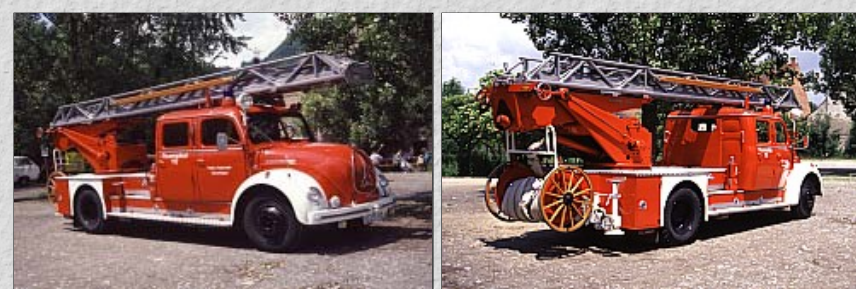
Die Drehleiter DL 25h - mit gleichem Aufbau, jedoch mit Doppelkabine! Im Bild rechts eine weitere Variante: Der Haspel des Wiking-Modells ist mit Metallrädern ausgerüstet - das Fahrzeug im Bild zeigt Holzspeichenräder.
