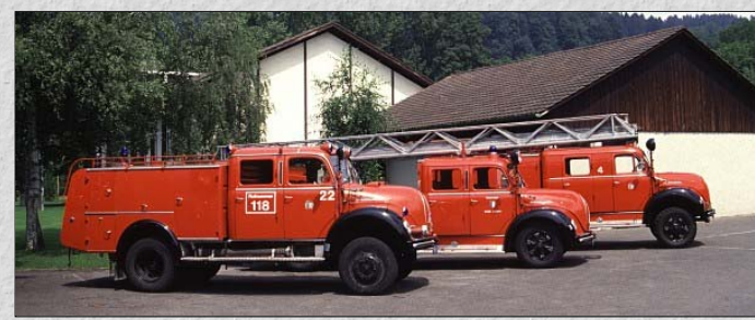
Der "Rundhauber"-Löschzug der Feuerwehr Luzern/Schweiz: TLF 16, DL 30 mit Doppelkabine, LF 16. Deutlich sichtbar hier das im Vergleich zum TLF sowie zum LF niedrigere Fahrerhaus der Drehleiter.
