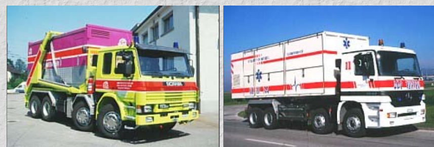
Dreiachsige Wechselladerfahrzeuge (WLF) der Feuerwehr Weinfelden/Schweiz auf MAN 25.372 (Bild links) und der Feuerwehr Schaffhausen/Schweiz auf Scania 124 G (Bild rechts).
