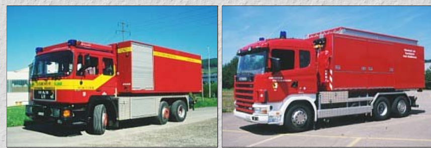
Dreiachsige Wechselladerfahrzeuge (WLF) der Feuerwehr Weinfelden/Schweiz auf MAN 25.372 (Bild links) und der Feuerwehr Schaffhausen/Schweiz auf Scania 124 G (Bild rechts).
