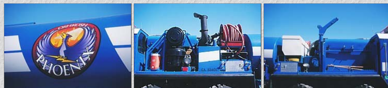
Im Bild links das Emblem des "Phoenix" auf blauem Grund inmitten von zwei abgeschrägten weissen Seitenstreifen, im mittleren Bild der linksseitige Bereich hinter dem Fahrerhaus mit Lüfter, Auspuffrohr, einer Schnellangriffseinrichtung sowie einem 5-gal-Trinkwasserbehälter -, im rechten Bild der rechtsseitige Bereich hinter dem Fahrerhaus.
